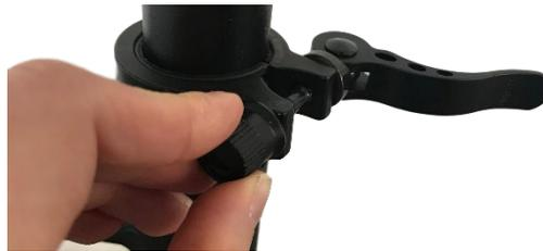
Ouvrez le collier de tige de selle et tournez le bouton de réglage : vers la gauche pour desserrer la pince, dans le sens des aiguilles d'une montre pour resserrer la pince.
