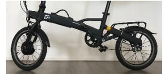
**⚠ PRUDENCE !** Lors du dépliage, la chaîne passe d'un état détendu à un état tendu. Cette transition doit être effectuée avec délicatesse : Il est important de laisser à la chaîne le temps et l'espace nécessaires pour se repositionner correctement sur les dents des pignons.
