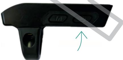
Utilisez les boutons + et – pour sélectionner facilement l'un des 3, 5 ou 9 niveaux d'assistance.
