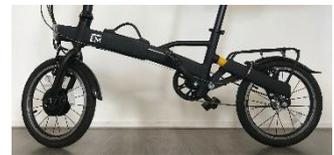
**⚠ AUFPASSEN!** Im aufgeklappten Zustand geht die Kette von einem entspannten in einen angespannten Zustand über. Tun Sie dies immer mit Aufmerksamkeit und Sorgfalt: Der Kette muss Zeit und Raum gegeben werden, um die Zähne der Ritzel wiederzufinden.
