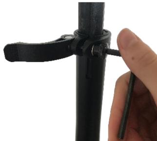
Mit einem 3mm-Inbusschlüssel die Klemme festziehen oder lösen:
