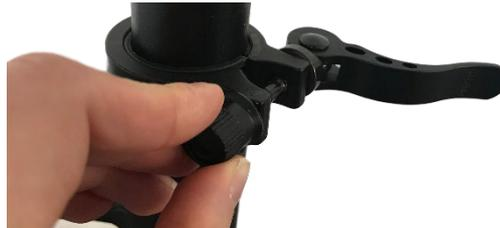
Öffnen Sie die Sattelstützenklemme und drehen Sie den Einstellknopf. Durch Drehen nach links wird die Klemme gelockert, durch Drehen nach rechts wird die Klemme fester.
